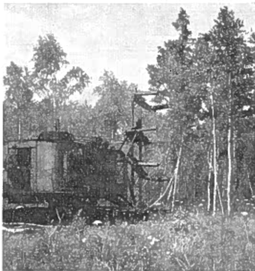
Kuva 1. Kasvaviiden puiden kaadossa käytetty erikoisrakenteinen kaivukone Tjosovan turvetyömaalla. (Valok. M. Salmi).
