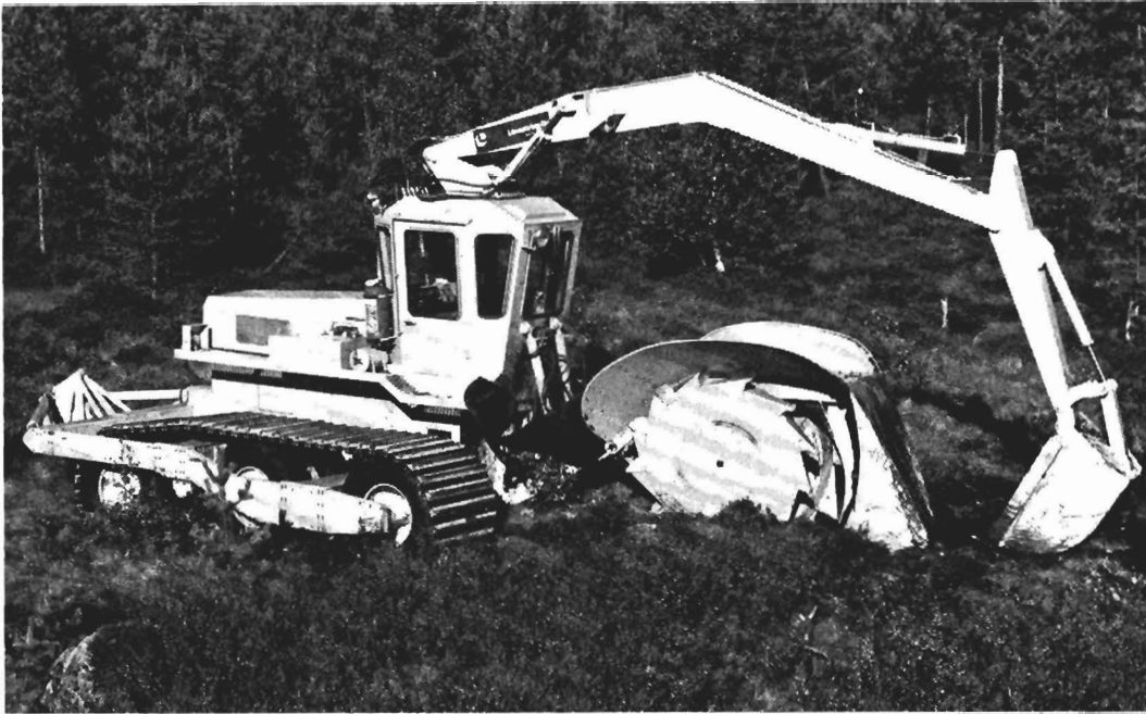
Kuva 4. Järeän luokan ojanperkaaja PERKO. Leveätelaiseen suotraktoriin asennettu hydraulinen jyrsin tekee perkauksessa päätyön, kaivulaitetta tarvitaan kuitenkin mm. kovissa paikoissa, risteyksissä ja raivaukseen. Lönnström Oy:n kuva.
