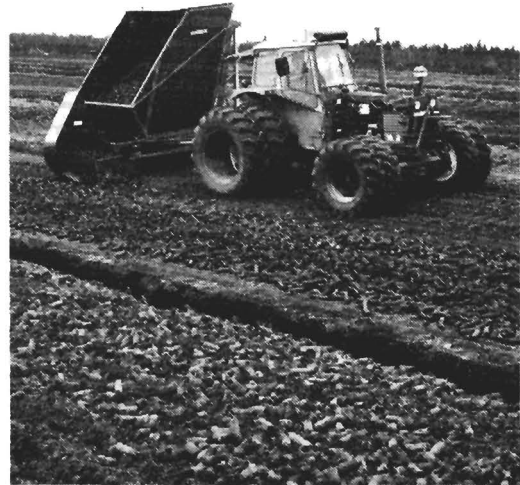
Kuva 3. Pientuotannossa palaturve kerätään tuotantokentältä yleisimmin keruuvaunuilla.
