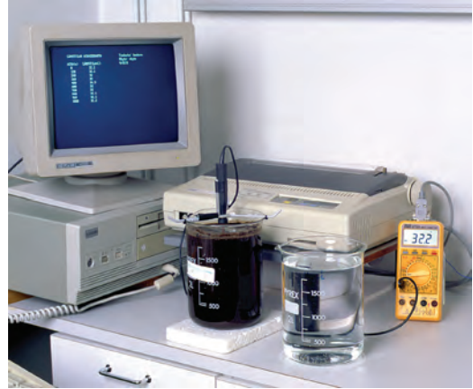
Kuva 2. Kylpyturvenäytteiden lämpöpidätyskyky mitattiin tarkoitusta varten kehitetyllä laitteistolla. (Kuva: Pekka Virtanen).
